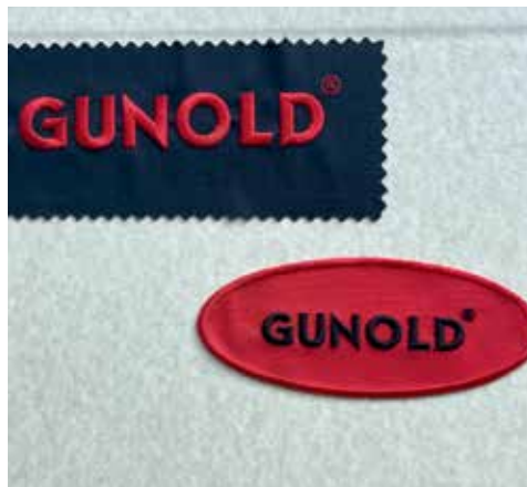
🇬🇧 Most common embroidery logo conversion today: satin stitch with 40-weight polyester thread. 🇩🇪 Häufigste Stick-Logo Umsetzung heute: Plattstich mit 40er Polyester Garn.
