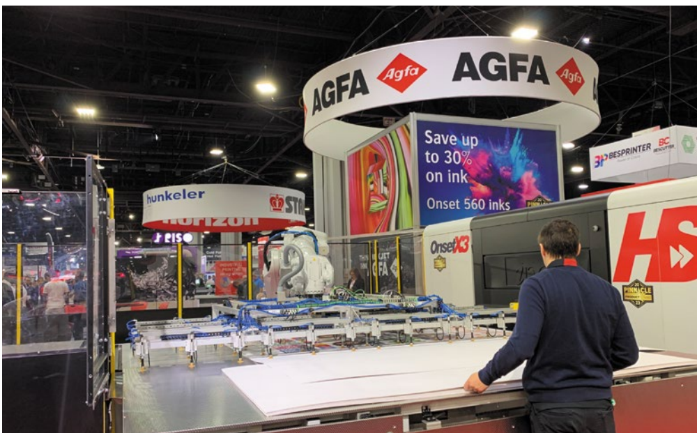
Automatisierung bei Agfa: Mittels Roboterarm werden die großformatigen Materialien abgenommen und dem Flachbettdrucker Onset X3 zugeführt.
